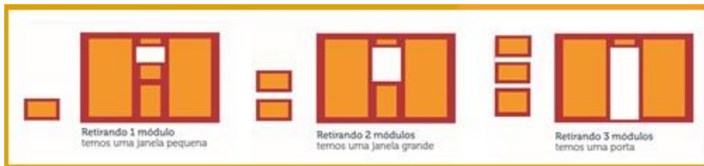
Figura 2. Módulo único de Painel construtivo que permite execução em alta produtividade mesmo em sistema de mutirão
