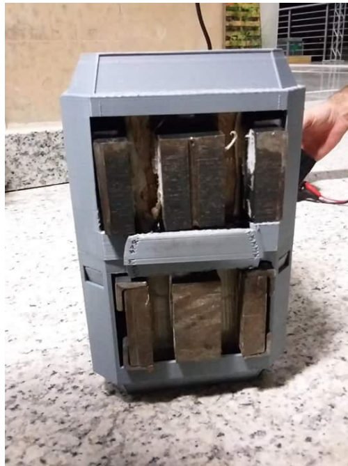
Figura 1 - Eletroímãs montados na base
