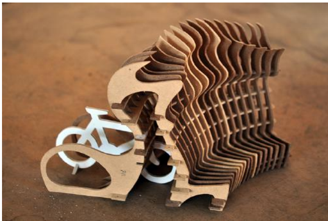
Figura 8: Maquete utilizada para verificação de aspectos estruturais e processo de montagem.
