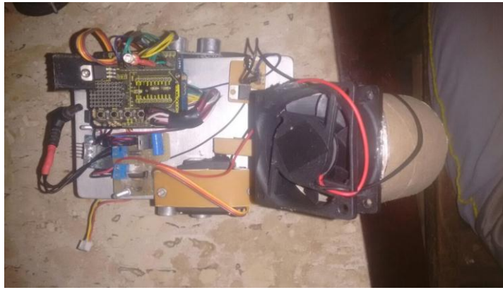
Figura 5 - Protheus: vista superior com detalhe para a protoshield e regulador de tensão
