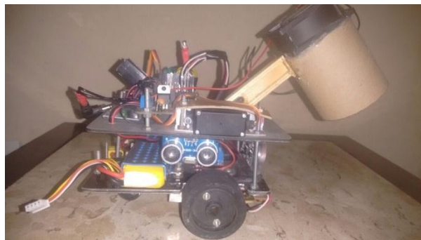
Figura 4 - Protheus: vista lateral com detalhe para o suporte da bateria
